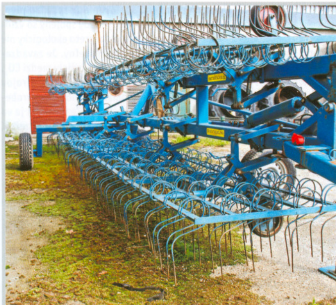
Prútové brány používajú ekologicky hospodáriaci roľníci nielen na reguláciu burín, ale tiež na skyprenie vrchnej vrstvy pôdy, čím sa zároveň podporí mineralizácia živín
